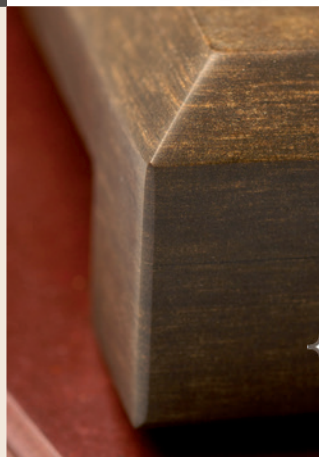
Esempio di lavorazione con bordo frontale riportato (built-in edge) Example of machining with the front edge back (built-in edge)
